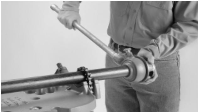
Рис. 3 – Установка инструмента на трубе.
