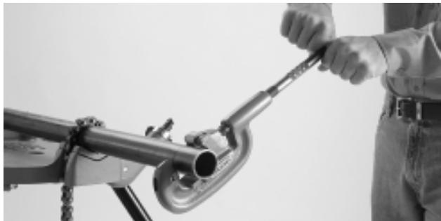
Рис. 1 – Резка края трубы
