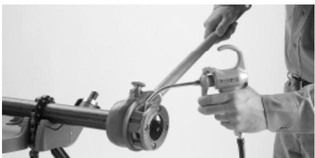
Рис. 4 – Нанесение резьбонарезного масла на трубу
